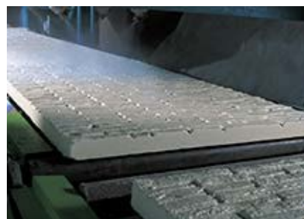
「ダイコンクリート」の塗装ライン。 耐久・耐候性を高める4重の塗装処理を実施
