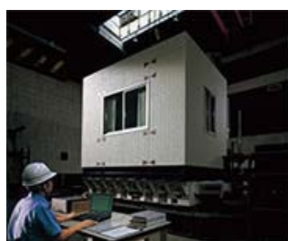
外壁実大振動実験で耐震性能を検証
