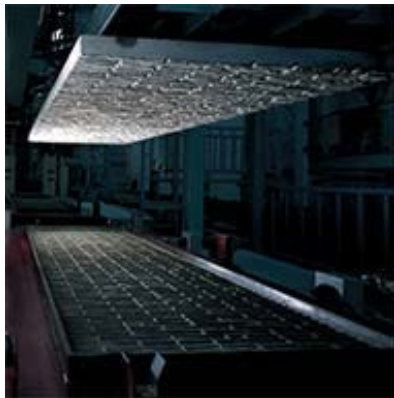
型枠に打ち込んだコンクリートを一定時間スチーム養生(1次養生)した後、型枠から外します
