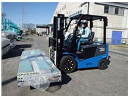
フォークリフトのバッテリー車化
