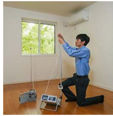
実大建物において、空間の化学物質濃度や経時変化を測定・評価
