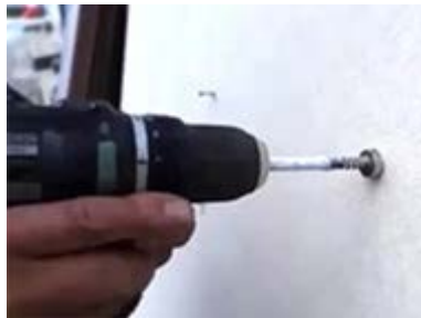
先端の磁石を用いてビスを探知する
