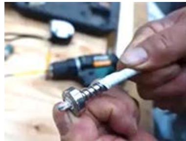
ビスを探知したら治具を押し込む。押し込むことでドライバービットが出てくる
