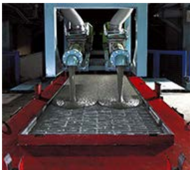
デザイン・形状共に豊富な外壁パネルは1枚ずつ型枠で成型
