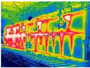
断熱化前の表面温度分布（高温）
